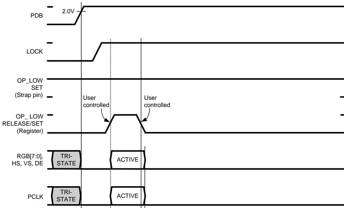
Figure 24. OP\_LOW Manual Set/Reset
