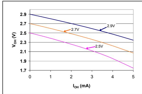
**FIGURE 2-23:**  $V_{OH}$  vs.  $I_{OH}$
