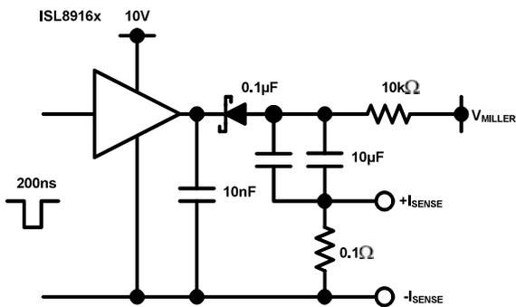
**FIGURE 5. MILLER PLATEAU SINK CURRENT TEST CIRCUIT**
