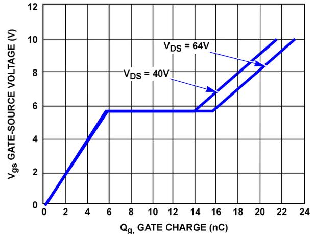
FIGURE 17. MOSFET GATE CHARGE vs GATE VOLTAGE
